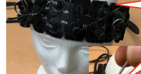
頭の大きさや生え際の広さによりますが、センサバンドを頭部に取り付けた際に髪の毛がセンサ部分と干渉することがよくあります(特に上部左右端の端子)
