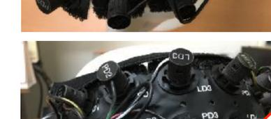
隙間から光が侵入しないように、センサバンド上部をすべて覆うようにベルクロを取り付けます
