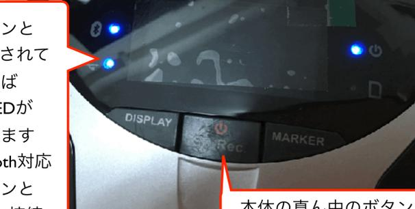
パソコンとUSB接続されていればこのLEDが点灯します (bluetooth対応パソコンとbluetooth接続している場合は上のLEDのみ点灯)
