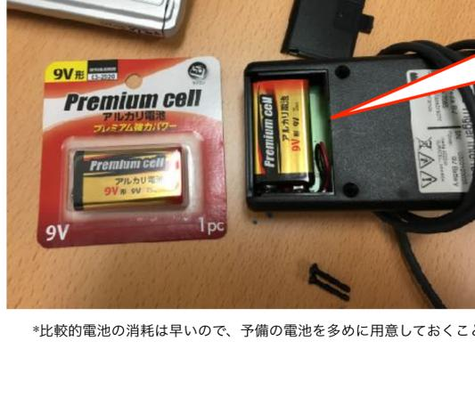
ネジ止めされている裏フタを開けて9V型の角型乾電池を入れ替えます
